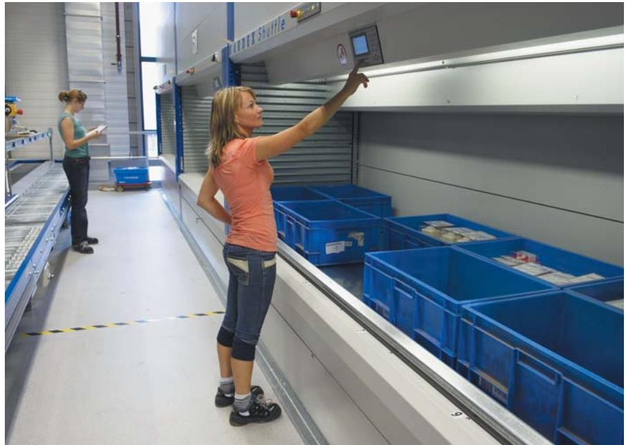
Автоматизированный лифтовой стеллаж высотой 11 м с площадью основания 5 кв.м, шириной поддона 1850 мм и глубиной поддона 610 мм предоставляет для груза высотой 120 мм полезную площадь хранения 80 кв.м (для сравнения: полочные стеллажи с равной площадью хранения займут до 40 кв.м склада).
